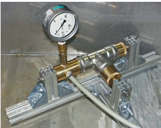
Abb. 12 Prüfaufbau Einzelprüfung 54 mm. (Quelle: FH BS/WF)
