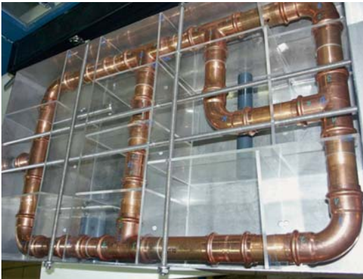
Abb. 11 Laufender Versuch mit Druckluft. Undichtheiten werden unter Wasser sichtbar. (Quelle: FH BS/WF)
