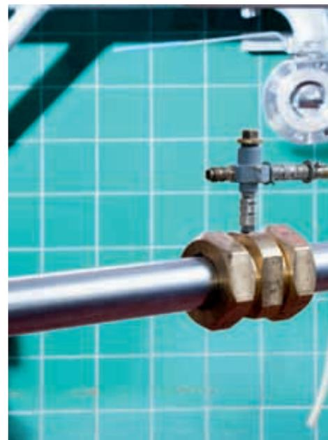
Abb. 8 Druckmessungen werden gleichzeitig im Verbindungsstück und im dazugehörigen prüfrohr durchgeführt.
